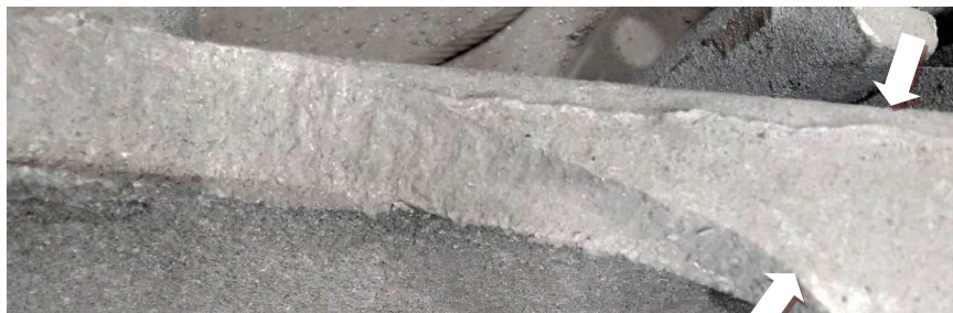
Рисунок 4 – Макроструктура излома нижней части секции ГСК (место отбора пробы №3)
