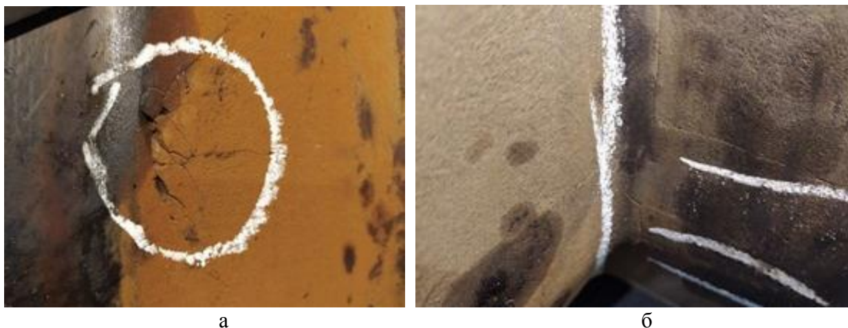
Рисунок 4 – Трещины (а) и сетка разгара (б) на первом калибре
