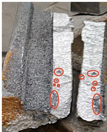
Рисунок 5 – Внутренние дефекты в верхней части секции ГСК (место отбора пробы №2)
