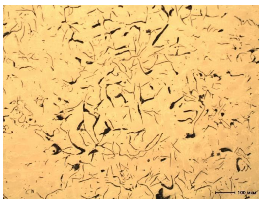
Рисунок 17 – Графит в образце №5
