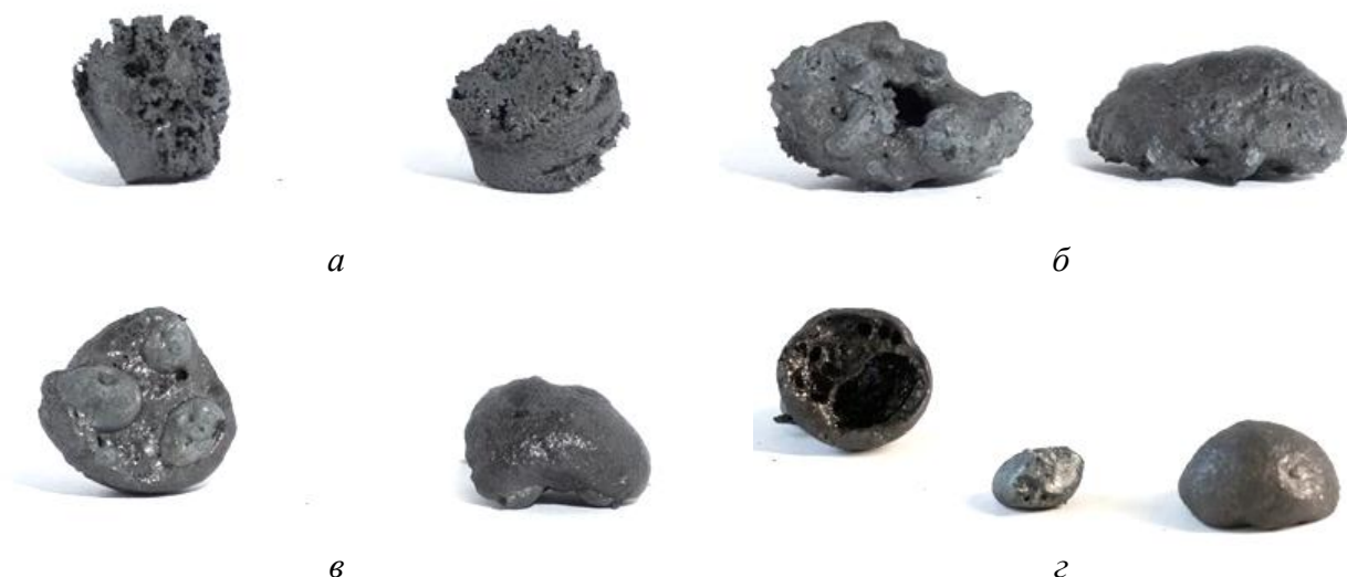
Рисунок 2 – Шлак и гранулы металла, полученные при температурах а – 1400 °C (шлак), б – 1425 °C (шлак), в – 1450 °C (шлак), г – 1475 °C (шлак и королек металла)
