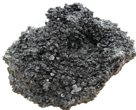
Рисунок 2 - Вторичный карбид кремния (образец взят при разборке ванны печи при выплавке технического кремния) Химический состав образца: SiC - 88,1% ; SiO 2 – 10,56%; Si – 0 %; C – 2,13 %
