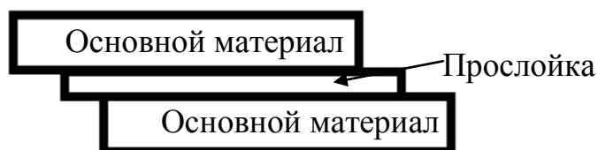
Рисунок 1 – Эскиз образцов для совместного деформирования
